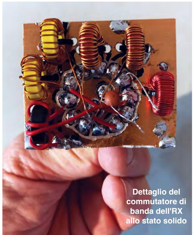
Dettaglio del commutatore di banda dell'RX allo stato solido
