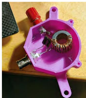
**Fig. 8** • Ecco il nostro 49:1, saldato al connettore BNC, con condensatore che collega polo caldo e freddo del connettore BNC e morsetto per collegare il nostro radiante
