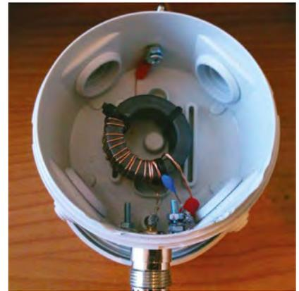
Fig. 4 • Un esempio di 64:1 "tradizionale", realizzato con trasformatore a isolamento galvanico tra primario e secondario
