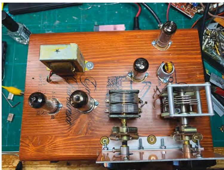
**Il ricevitore a valvole visto dall'alto**
