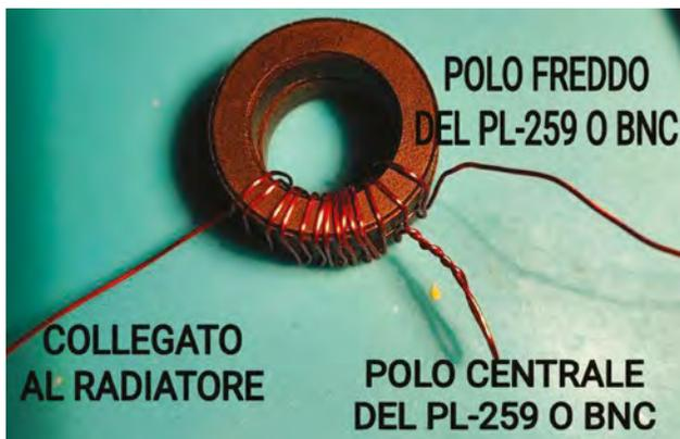
**Fig. 7** • Il risultato finale del nostro trasformatore di impedenza, prima di saldare e inscatolare il tutto
