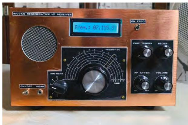
Ricevitore a reazione allo stato solido visto di fronte
