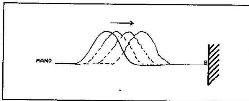
② Esempio di propagazione dell'onda diretta.
